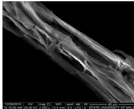
Gambar 4.9 Hasil Karakterisasi dengan SEM (Olympus CX 31) pada Enceng Gondok Bagian Batang pada perbesaran 2500x
