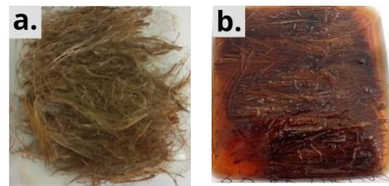
Gambar 1. a. Perlakuan 5% alkali pada serat, dan b. Sampel setelah di keringkan
