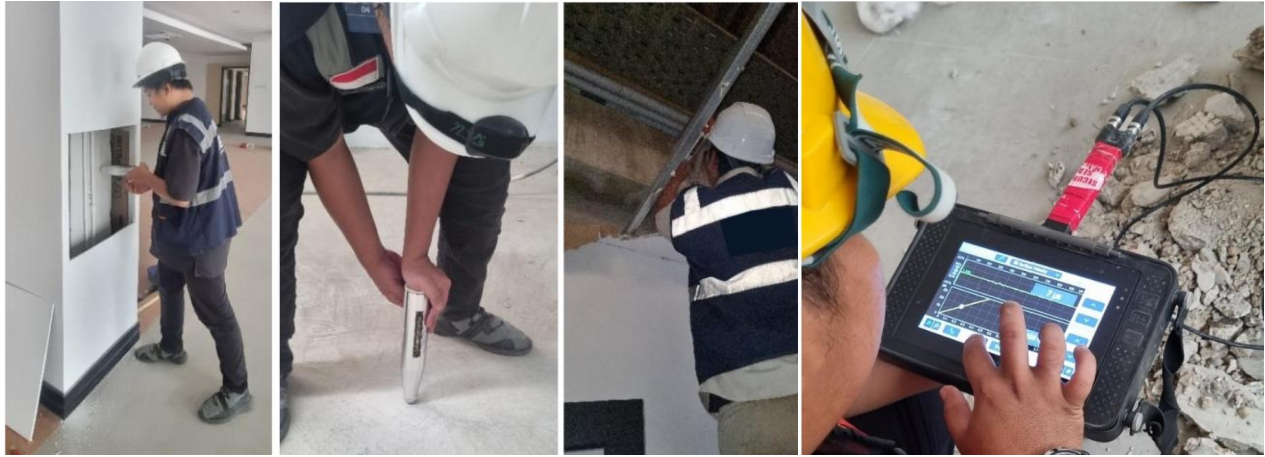
Gambar 2. Titik Pengujian Hammer Test dan UPV ( gambar lapangan )
